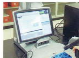
◀ 3D測定器です 物体の高さ 角度などの測定が出来ます。
